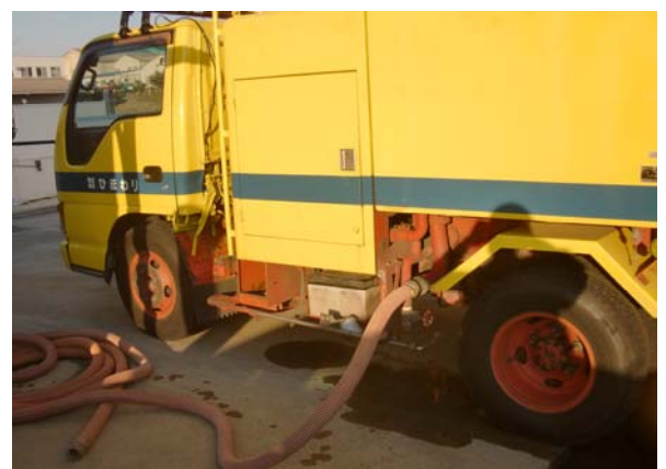
【洗浄車への雨水給水】
